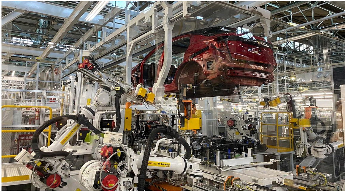
Рис. 1 - Роботизированная линия сборки автомобилей на предприятии Nissan.
